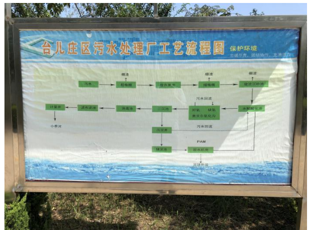
台儿庄污水处理厂污水处理工艺流程图
